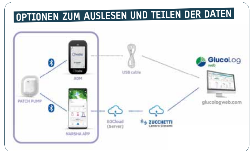
Abb. 3: Die Daten können aus dem ADM mittels USB-Kabel ausgelesen bzw. via App in einer Cloudlösung gespeichert und in die Software GlucoLog web übertragen werden.
